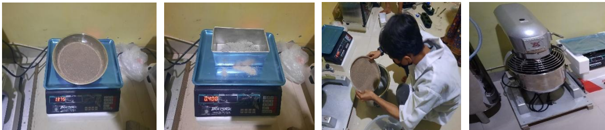
Gambar.3 Proses Pembuatan Benda Uji Mortar
