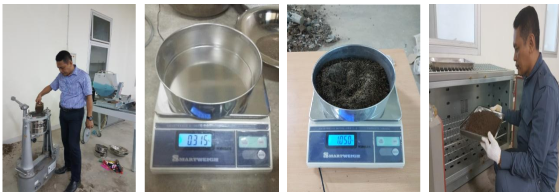
Gambar. 2. Pengujian kadar air dan analisa saringan agregat halus
