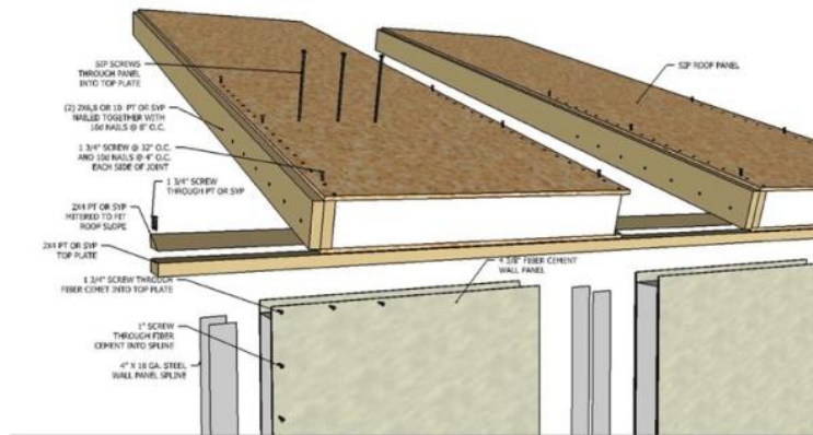
Gambar 8. Sambungan antar SIPs
