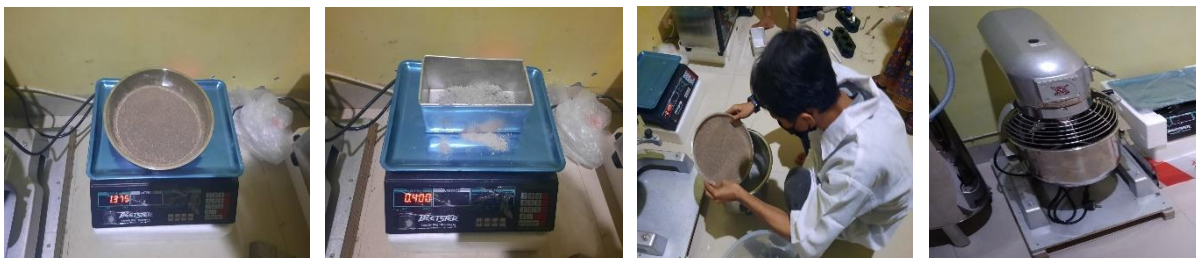
Gambar.3 Proses Pembuatan Benda Uji Mortar
