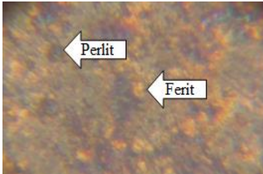
Gambar 4.13 Foto struktur mikro spesimen hasil packcarburizing pada temperatur 900°C
